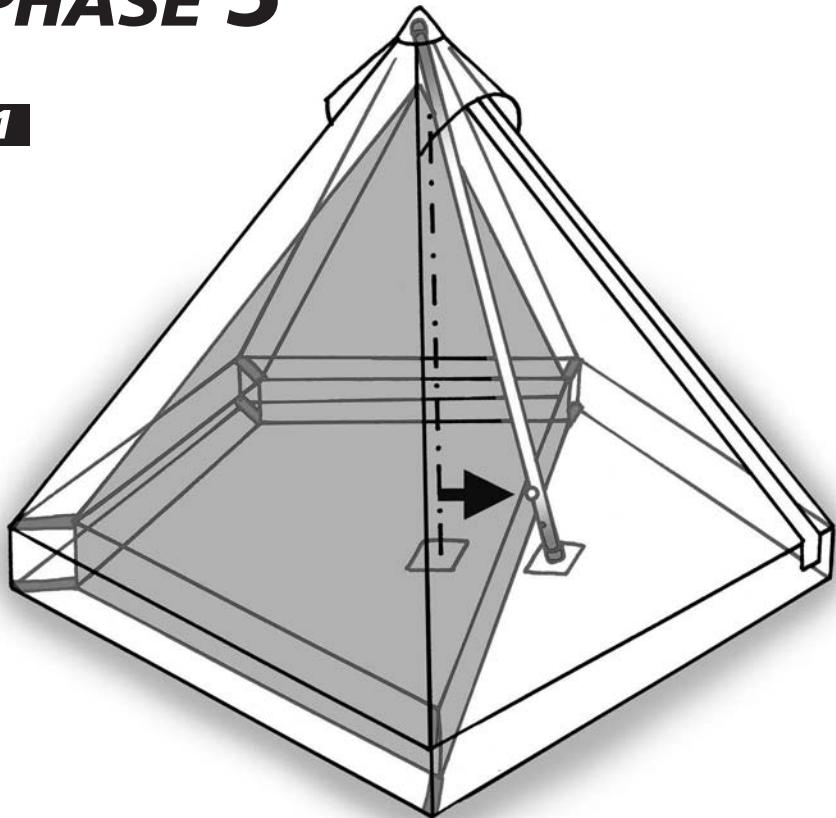
D Zum **finalen Abspinnen (1)** schließen Sie wieder die Reißverschlüsse des kompletten Zeltzugangs (auch am Moskitonetz) und spannen sie die 5 Bodeneckbänder an den Metallstäbchen straff ab (2).
