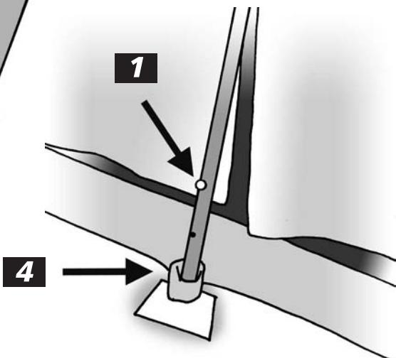
**D** Um das Innenzelt ohne Raumverlust zu nutzen, versetzen Sie die **Aufstellstange** leicht schräg von der mittleren Bodenverstärkung auf die zum Zelt-Eingang hin **versetzte zweite Bodenverstärkung**. Dazu müssen Sie die **Aufstellstange verlängern** und den Einstellknopf in die zweite, **obere Position** einrasten lassen (1).
