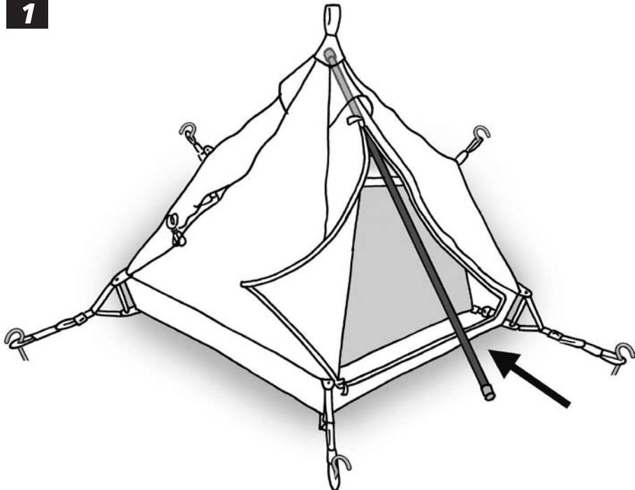
**D** Rasten Sie den **Einstellknopf** der Aufstellstange in der ersten, **unteren Position** ein um die kürzeste Länge der Stange zu erreichen.
